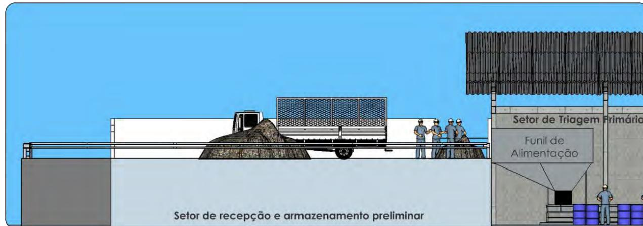
Figura 165 – Detalhe do desnível entre o setor de recepção e armazenamento preliminar e o setor de triagem primária da UTR.
