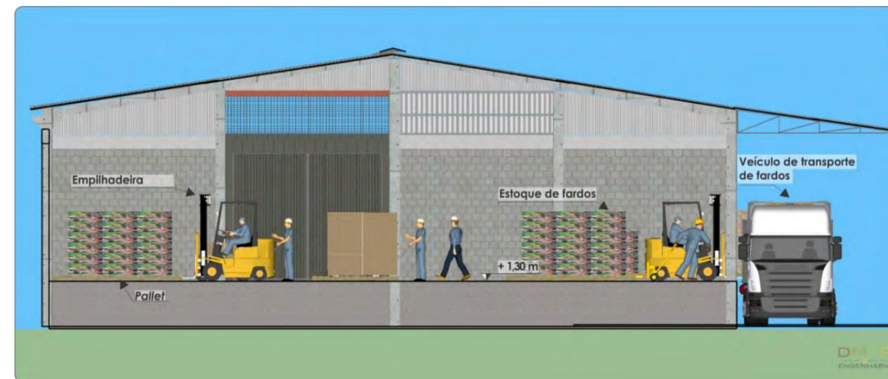
**Figura 169 – Corte transversal do setor de estocagem e expedição de fardos, destacando o desnível facilitador da operação de carga.**
