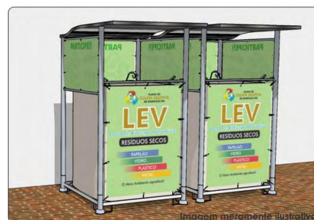
**Figura 152 – Proposta de LEV para o município de Maracaju/MS com a utilização de dispositivo em estrutura metálica para suporte de big bag para o acondicionamento dos resíduos.**
