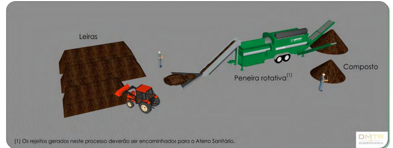
**Figura 182 – Ilustração esquemática destacando as “peneiras rotativas” da Unidade de Compostagem.**
