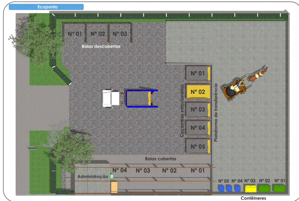
Figura 188 – Disposição dos espaços físicos do Ecoporto (vista em planta) para o recebimento de resíduos dos pequenos geradores.
