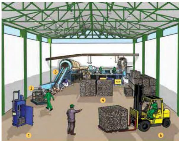
**Figura 163 - Layout interno de um Galpão de Triagem, apresentando alguns equipamentos necessários.**
