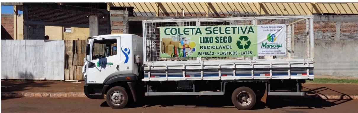
**Figura 76 – Veículo coletor com implemento do tipo gaiola utilizado na coleta seletiva Porta a Porta em Maracaju/MS.**
